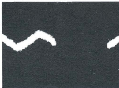
Fig. 31 - La presenza di ronzio e di rumore di fondo all'uscita di un amplificatore. Essi possono essere misurati agevolmente, ma non possono essere visualizzati separatamente l'uno dall'altro. La parte mancante dipende dalla velocità dell'otturatore.
